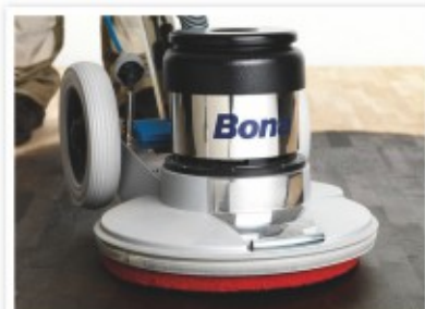
Leštění pomocí talířové brusky – Rozneseme v tenké vrstvě
